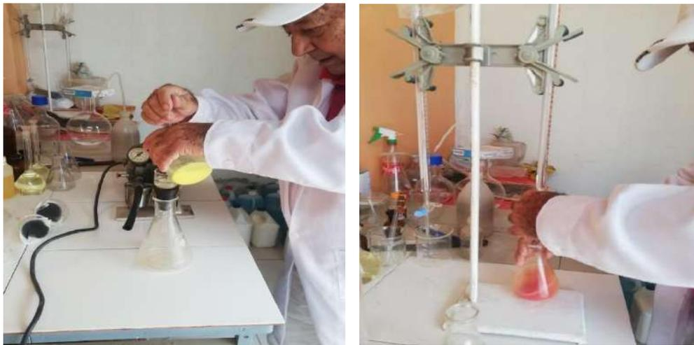
**Figura 22. TITULACIÓN DEL FÓSFORO Y FIN DE LA TITULACIÓN:** obteniendo el precipitado del fosforo se cuantifica con una solución estandarizada de hidróxido de sodio.
