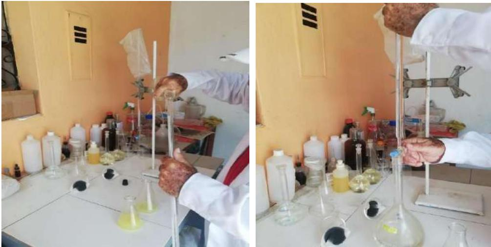
**Figura 21. PRECIPITACIÓN DEL FÓSFORO:** el fosforo se precipita con una solución acida de heptamolidado de amonio
