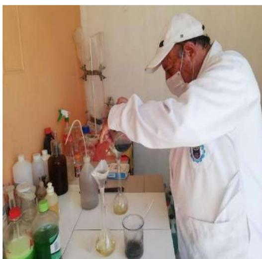
**Figura 18: FILTRADO DE LA MUESTRA DESPUES DEL ATAQUE**
