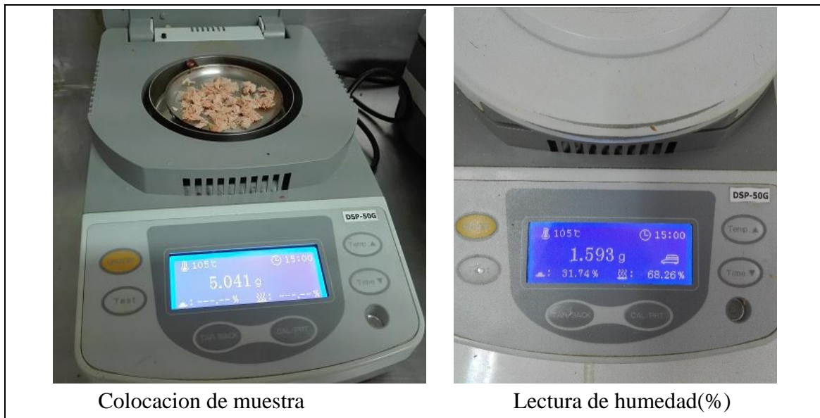
FIGURA N°4.11: ANALISIS DE HUMEDAD EN TERMOBALANZA
