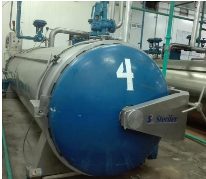
Figura 3.11: Autoclave horizontal Estacionaria
