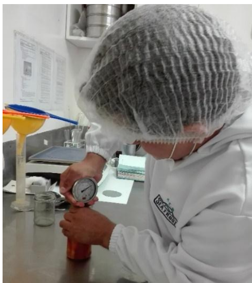
FIGURA N°4.7: Medición del vacío con vacuómetro
