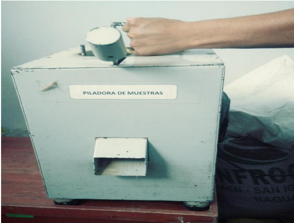
Figura A1.15. Piladora de café
