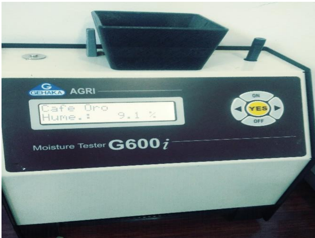
Figura A1.18. Medición de la humedad
